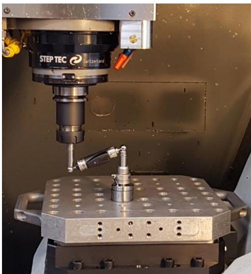
Figure 2 : Exemple de caractérisation sur machine HSM600U du LaBoMaP à gauche grâce à un Ballbar QC20-W à droite
