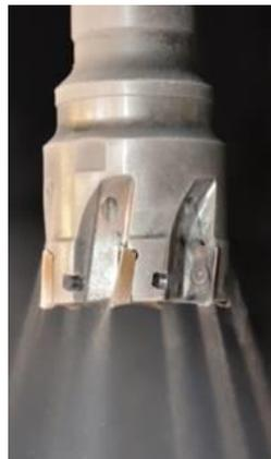
Fraise à plaquette WC conçu pour l'assistance cryogénique (LaBoMaP&Iscar),
