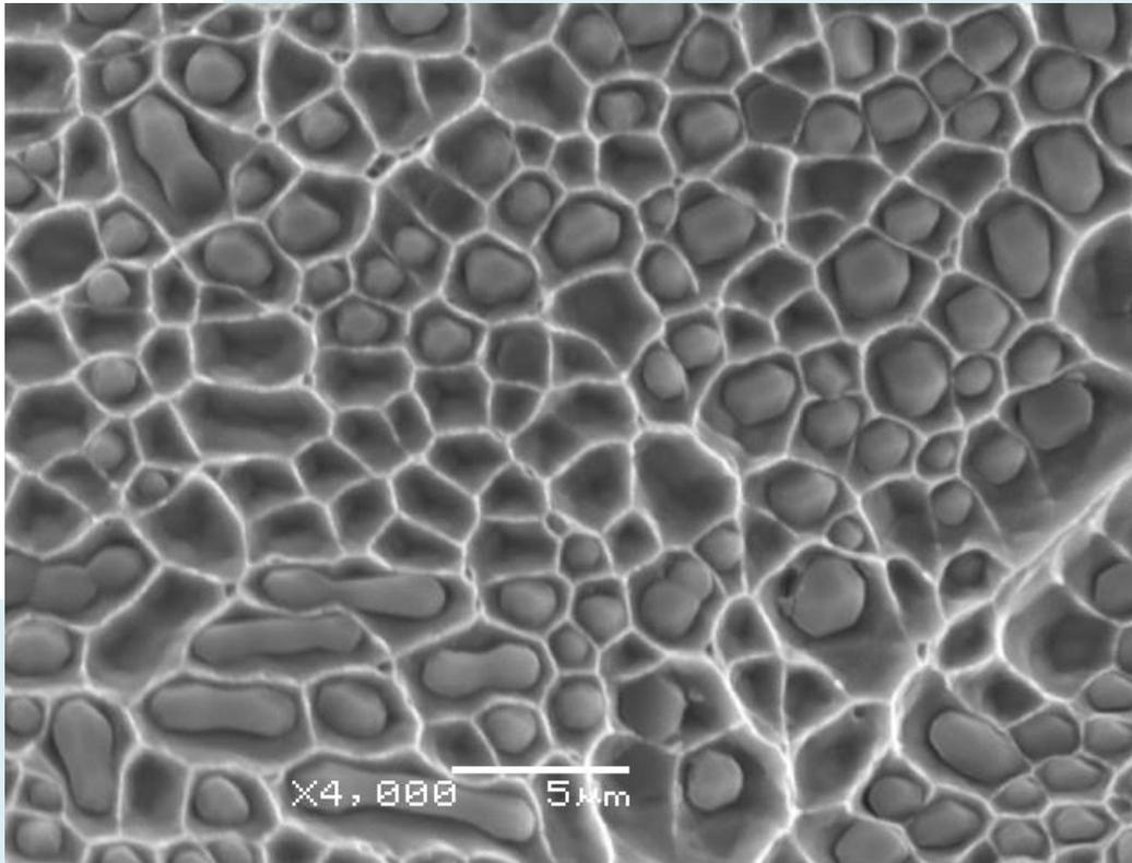
C'est la réponse n° 1 : Un faciès de rupture dans un alliage léger.
