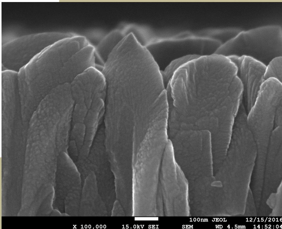
C'est la réponse n° 3 : Un détail sur un dépôt métallique.
