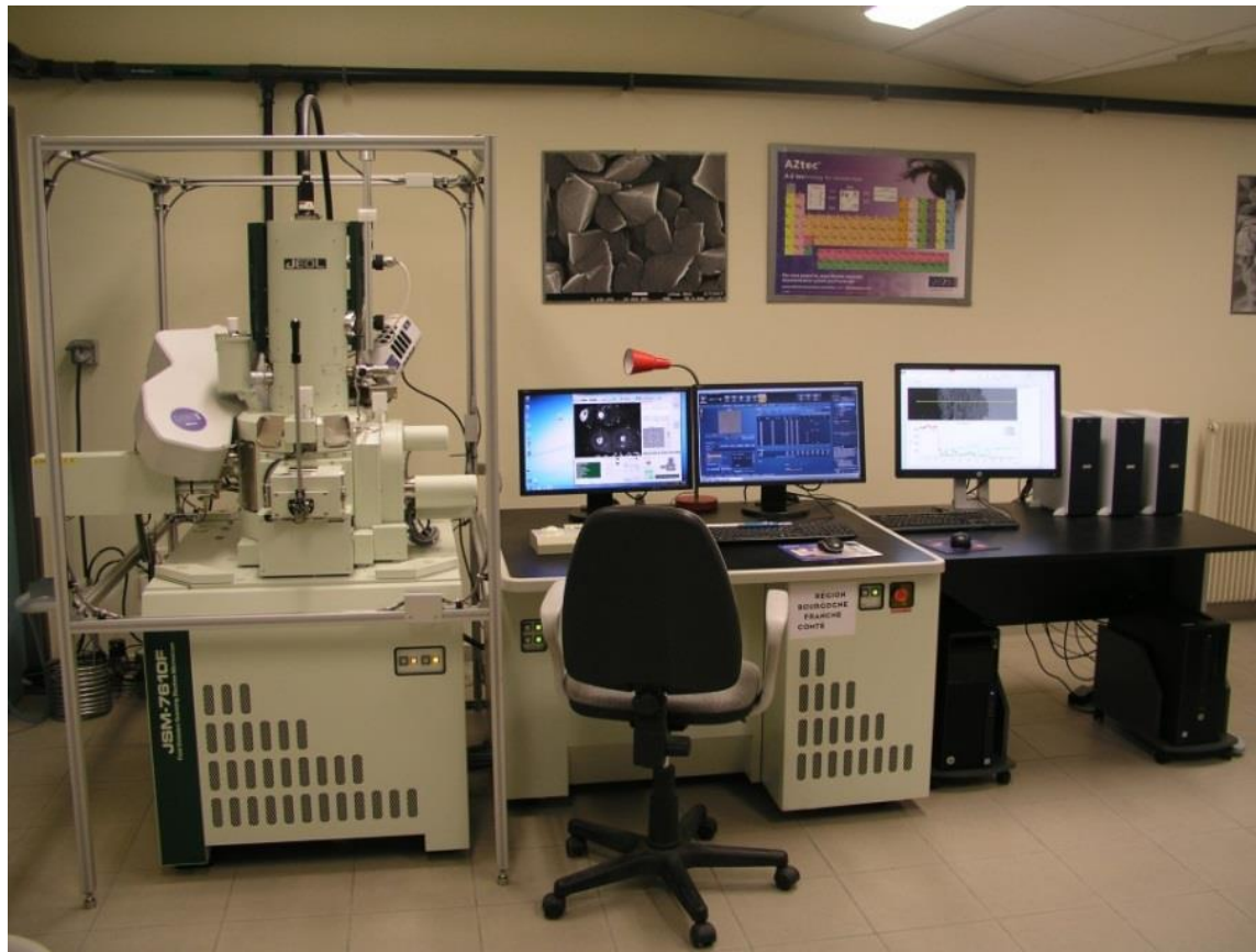
Photo du microscope électronique à balayage JEOL 7610 F équipé de deux détecteurs de rayons X OXFORD Instruments. Coût de l'investissement : environ 400 k€.
