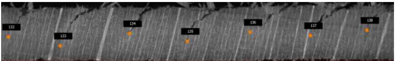
Figure 2 : Fissuration cyclique d'un placage de hêtre (pénalisant pour l'usage du placage)
